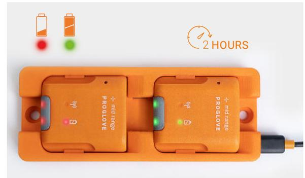
Die Pins zeigen nach unten. Scanner in die Ladestation einsetzen.
