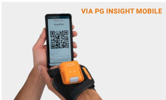
Auf dem Endgerät das Appsymbol "PG Work" öffnen und den Pairing Barcode scannen.
