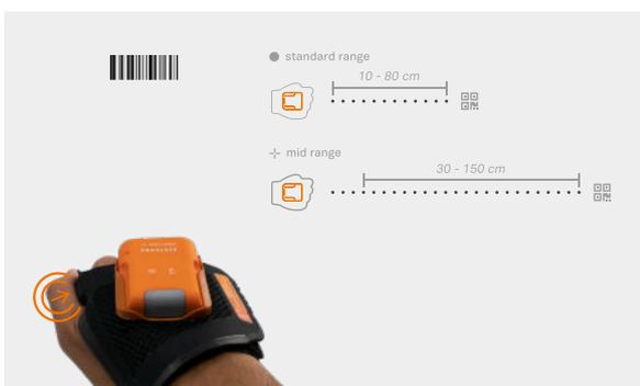
Den Textil-Auslöser gedrückt halten. Barcode analysieren und scannen.
