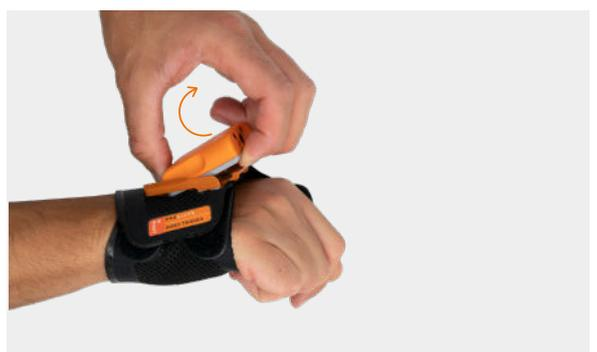
Mit den Fingern zwischen Scanner und dem Befestigungsclip drücken. Scanner leicht nach oben drücken und nach vorne wegschieben ohne über die Pins zu kratzen.
