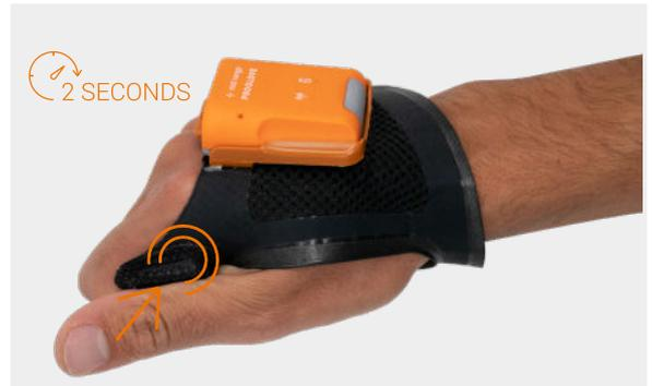
Den Textil-Auslöser am Index Trigger drücken um den Scanner zu aktivieren.
