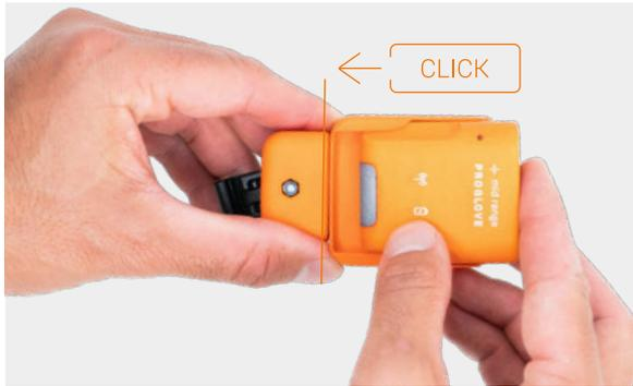
Den Scanner in den Reel einsetzen.
