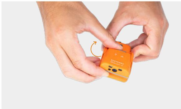
Mit den Fingern zwischen Scanner und dem Befestigungsclip drücken. Scanner leicht nach oben drücken und nach vorne wegschieben ohne über die Pins zu kratzen.
